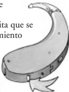
**Paso 2:** Remueva la pestañita de color que se encuentra en la batería nueva colocando el lado positivo “+” mirando hacia afuera, favor de prestar atención especial al signo de “+” que se encuentra en el lado de la puerta de la batería.
